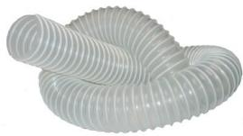
Gaine en polyuréthane (PU) très flexible et durable, qu'on peut utiliser pour le transport d'air de matières abrasives. Qualité résistant à l'hydrolyse et aux bactéries. Grande résistance à l'abrasion et à la déchirure. Mise à la terre par connexion des extrémités du fil d'acier.
